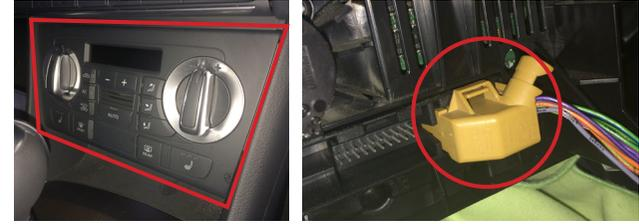
**Audi A4, A5 Q5** Connecteur du contrôleur de climat
